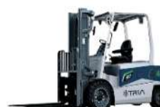
CPD40/50 LI Capacidade de 4 T a 5 T Controlador ZAPI Bateria de lítio
