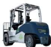
CPD60/70 LI Capacidade de 6 T a 7 T Controlador ZAPI Bateria de lítio
