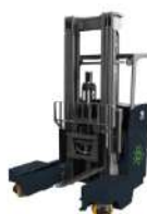
MQ25 Capacidade nominal 2500kg Altura máxima de elevação 8000mm
