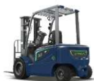
CPD15/18/20/25/30/35/38 Capacidade de 1,5 T a 3,8 T Altura de elevação 3000-7000mm Bateria de lítio
