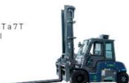
CPD85/100 LI Capacidade de 8 T a 10 T Controlador ZAPI Bateria de lítio
