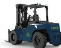
EFL803/1003-HV Capacidade 8/10 T Altura de elevação 3000-7000mm Bateria de lítio Controlador AC
