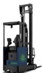
CQD16L Capacidade 1,6T Altura de elevação 2700-8000mm Bateria de lítio Controlador AC
