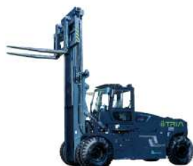
CPD200/250/280/300/320/350-A19LiG2-12 Capacidade 20/25/28/30/32/35 T Altura de elevação 4000mm Máx. altura de elevação 8000mm Cabine fechada Bateria de lítio Controlador AC
