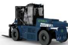
EFL1603/1803-HV Capacidade 16/18 T Altura de elevação 3500-5000mm Bateria de lítio Controlador AC
