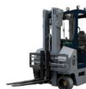
MQK30 Capacidade nominal 3000kg Altura máxima de elevação 8000mm
